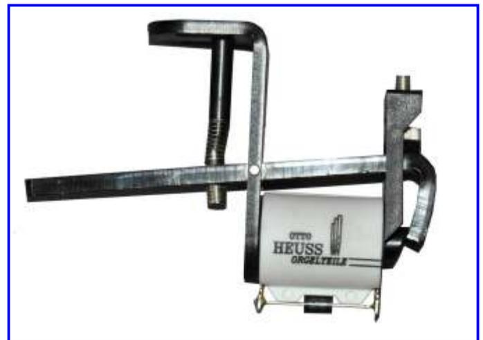
Der Anker des Wippmagneten ist mittels Feder einstellbar. Es ist dadurch möglich, die Zugkraft des Magneten zu optimieren. Die Gangbegrenzung oberhalb des Ankers ist leicht zugänglich, je nach Bedarf auch abweichend zur Werkseinstellung. Der Magnet ist genau auf die Belange der Windlade einzustellen und nachträglich noch gut zu justieren.
