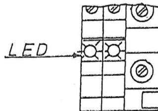
Wenn die Polarität stimmt, die Steckkarten einzeln einstecken und sofort die Funktion überprüfen. Dies wird bei jeder weiteren Steckkarte so gehandhabt. Vor dem Einstecken muß die Orgel ausgeschaltet werden.
