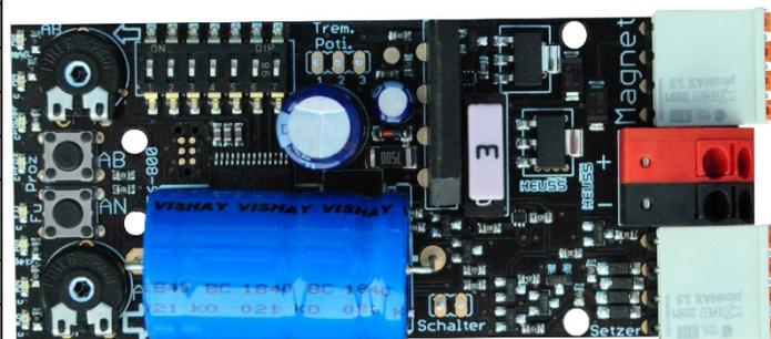
Ist Dip-Schalter 5 eingeschaltet, so leuchten die LEDs der Eingänge Setzer-AN und Setzer-AB invertiert zum normalen Betrieb. (Ähnlich Eingang „Funktion“)
