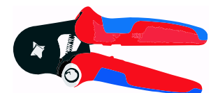
6060-030 Aderendhülsenzange - 0,08mm 2 bis 16mm 2 Aderendhülsen - Kraftverstärkung durch Kniehebel - Vierkantpressung für optimale Kontaktflächen in Klemmanschlüssen
