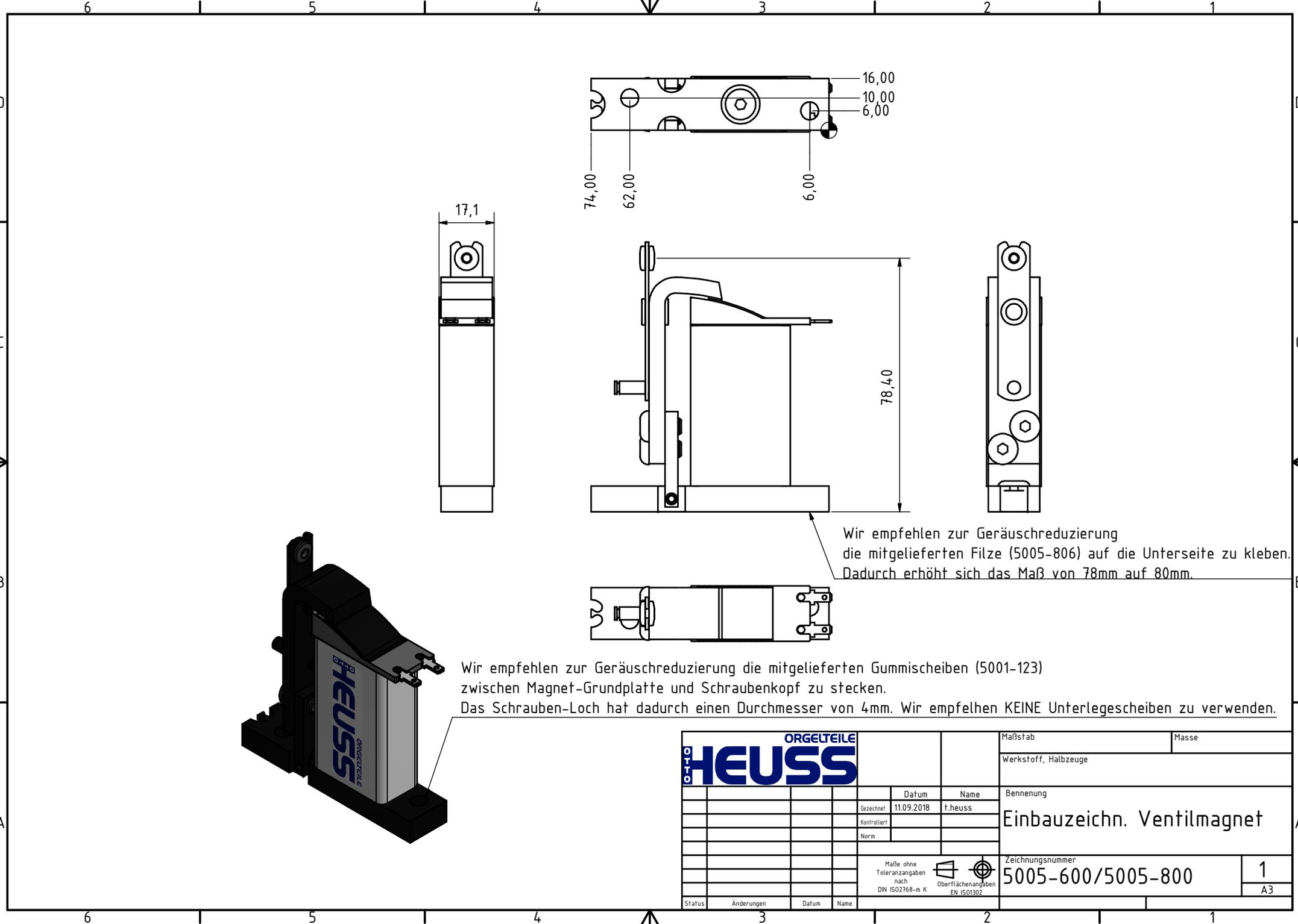
Wir empfehlen zur Geräuschreduzierung die mitgelieferten Filze (5005-806) auf die Unterseite zu kleben. Dadurch erhöht sich das Maß von 78mm auf 80mm.
